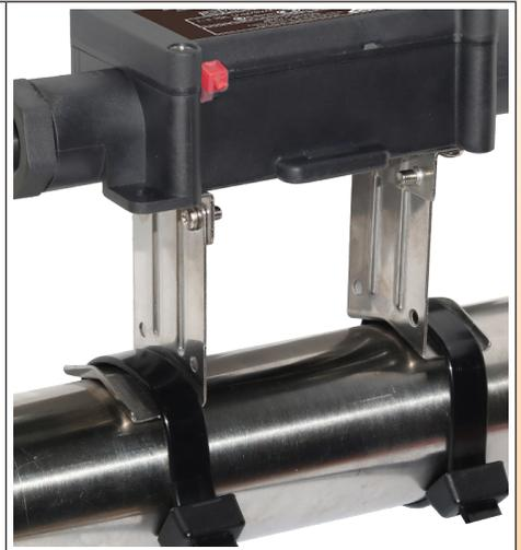
3: Eine Halterung aus Edelstahl für die Abstandsmontage an Rohrleitungen, mit der sich der Kasten nach der Installation der Isolierung und des Schutzes arretieren lässt. Sie erlaubt eine Dämmstärke von 50 mm und kann an heißen Rohren verwendet werden. Befestigung an Metall- oder PVC-Rohrleitungen mit Nylonband oder Metallschelle (Füße sind als Zubehör erhältlich).
