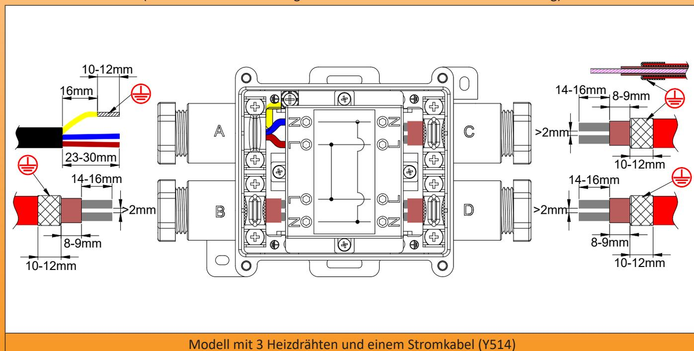
Modell mit 3 Heizdrähten und einem Stromkabel (Y514)
