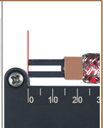
4: Eingravierte Skala in cm, mit mechanischem Anschlag bei 0 cm, um die Messung der Abisolierlänge zu erleichtern.
