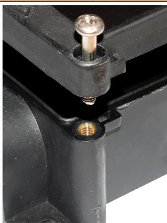
1: Vier unverlierbare Schrauben aus Edelstahl, die auf Metalleinsätzen befestigt werden. Kein Eindrehen in den Kunststoff, keine zerbrechlichen Scharniere.
