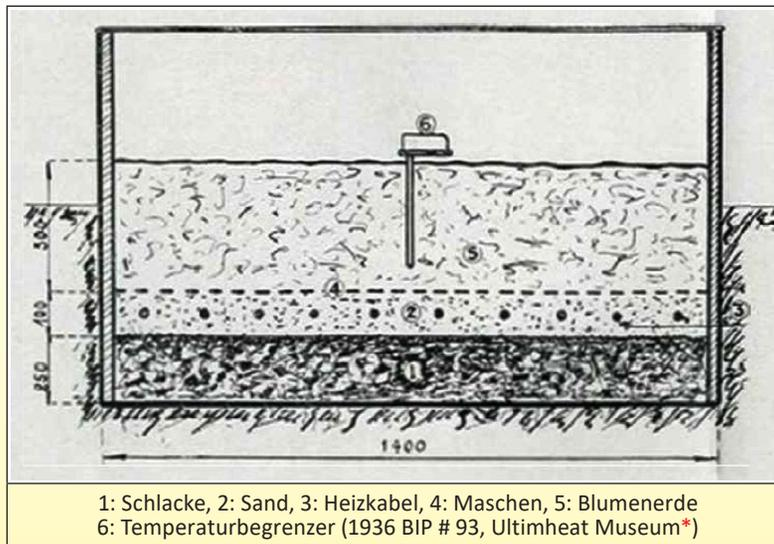
Die Anwendung der elektrischen Schichtheizung im Gartenbau hat sich in Frankreich schnell entwickelt, und dieser Heizkabeltyp wurde schnell von zwei großen französischen Anbietern standardisiert: Câbles de Lyon und Alsthom, die einen geraden Heizdraht und in einigen Fällen eine niederländische Anbieter, die Hollandse Draad in Kabelfabrik (Draka) aus Amsterdam, die einen spiralförmigen Heizdraht um einen Asbestkern verwendeten.
