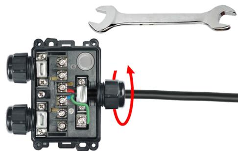
4: Schieben Sie die Rundkabel-Dichtung in die Kabelverschraubung und ziehen Sie die Mutter fest. Maximales Drehmoment 3 N.m.
