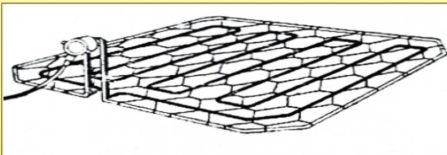
1956, Beispiel eines 1,5 m<sup>2</sup> großen Gitters, das einen Heizmantel trägt, zur Beheizung von Schichten im Gartenbau. (1956 Elektrische Heizung im Gartenbau, Ultimheat Museum\*)
