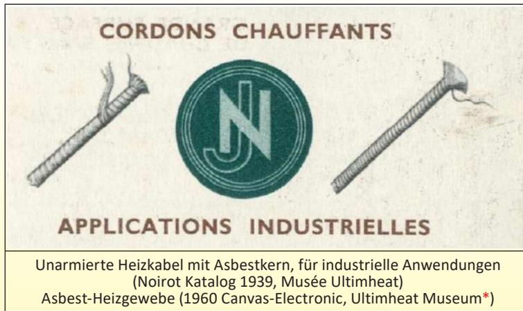
Eine weitere wichtige Anwendung sind Heizkabel, die aus einer kalibrierten Asbestperle bestehen, auf die der Metallleiter gewickelt und mit Asbestgeflecht oder anderen isolierenden Stoffen ummantelt ist (oder auch nicht).
