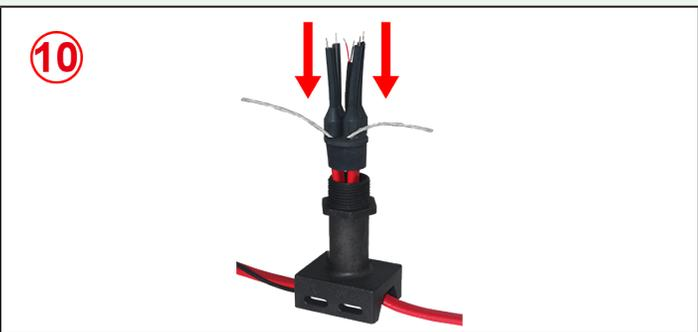
**10:** Schieben Sie die Isolierschläuche über die Leiter der Heizkabel und lassen Sie den Schutzleiter draußen.
