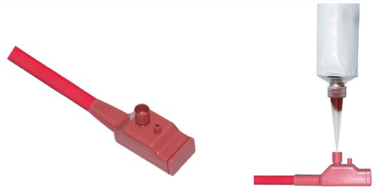
10: Legen Sie die Einheit auf eine waagerechte Fläche und füllen Sie flüssiges RTV-Silikon durch den Einfülltrichter ein, bis das Silikon in der kleinen Entgasungsöffnung aufzusteigen beginnt. Lassen Sie es etwa 24 Stunden lang aushärten.
