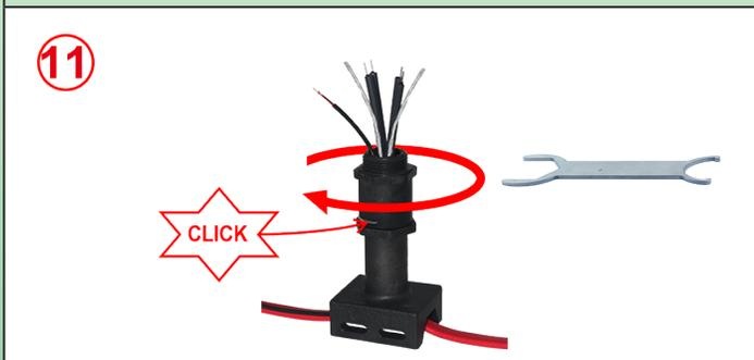
**11:** Drücken Sie die Dichtung zusammen, indem Sie den oberen Teil des Fußes anschrauben. Nach dem Festziehen kommt eine kleine Feder zum Einsatz, die das Ganze versperrt (zur Demontage ist es notwendig, diese kleine halbkreisförmige Feder zu entfernen). Nun ist es möglich, das Bein zu installieren, indem man ein 32,5 mm Loch in den ausgewählten Kasten bohrt.
