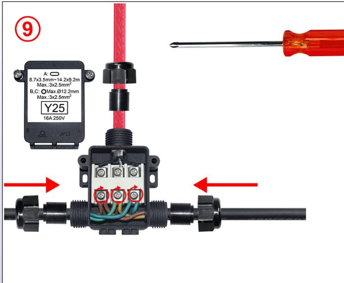
**9** : Führen Sie den abisolierten Teil der Stromversorgungsleiter in die Klemmen ein und ziehen Sie sie mit einem Schraubendreher fest. 2 Leiter in jeder Klemme, auf jeder Seite des Sattels. Empfohlenes Anzugsdrehmoment 1,2 N.m.
