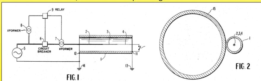
Auszug aus einem Patent von Masao Ando aus dem Jahr 1968 für das Unternehmen Chisso in Osaka, in dem die Beheizung von Rohrleitungen durch ein Wirbelstrom-Heizrohr beschrieben wird.
